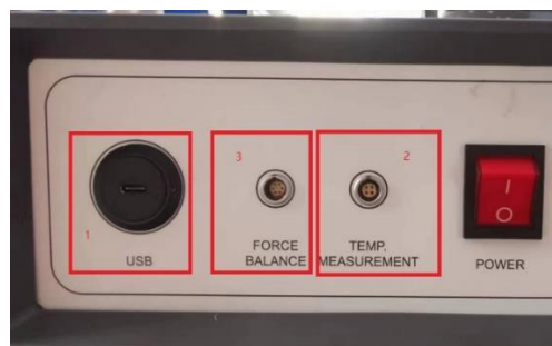
图 4 DAQ16 数采仪背板及 1 数据线、2 温度传感器、3 天平插口照片
